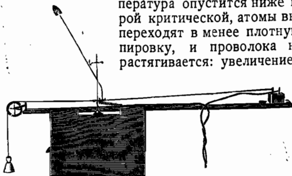
Рис. 112. Железная проволока растягивается повешенным грузом. Стрелка показывает удлинение. Проволока нагревается электрическим током.
